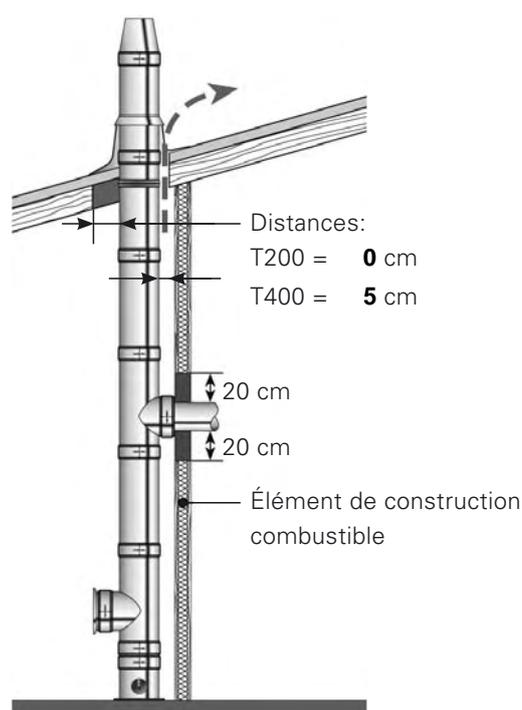
Si **ICS** est disposé **dans le bâtiment**, il faut prendre en compte qu'un **revêtement EI** continu – EI 30 pour maison particulière et EI 60 pour immeuble collectif – (jusqu'à la couverture du toit) est nécessaire sur le pourtour.
